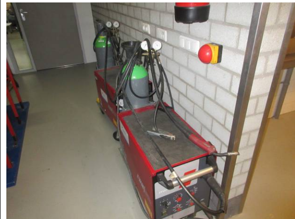
MIG/MAG lassets (gebouw 1)
